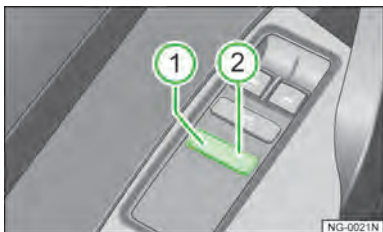
图 49 驾驶员侧车门内：中央门锁按钮。
