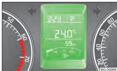
图 27 车辆信息显示装置
