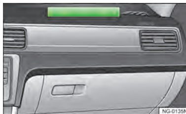
图 11 仪表板上的前排乘员正面安全气囊
