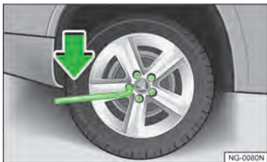
图 167 更换车轮：松开车轮螺栓
