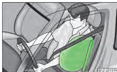
图 15 已充气的侧面安全气囊
