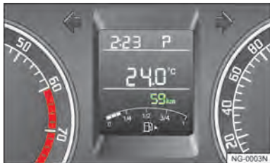
图 41 车辆总行驶里程计数器
