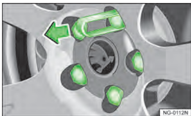
图 166 从车轮螺栓上拔下盖罩
