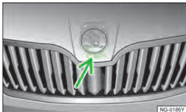
图 149 打开发动机舱盖
