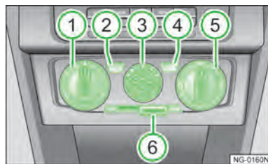
图 119 中控台上：手动空调的操作元件
