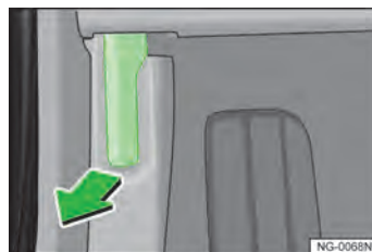
图 148 发动机舱盖解锁拉手
