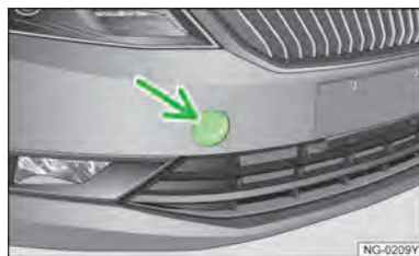
图 170 在保险杠的右前部：拆卸盖板
