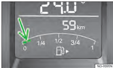
图 143 组合仪表局部视图：燃油存量表
