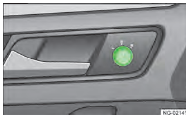
图 79 在驾驶员侧车门内：电动车外后视镜旋钮
