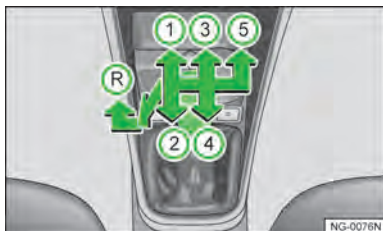
图 129 5 档手动变速箱档位示意图
