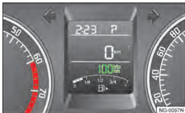
图 42 车辆短程行驶里程计数器
