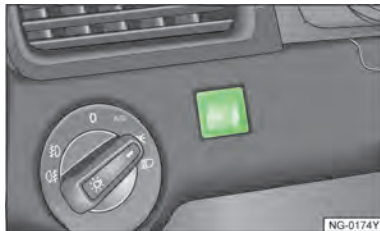
图 67 在方向盘旁边：大灯照明距离调节的调节器
