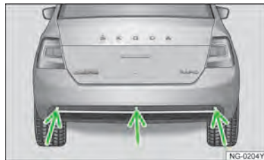
图 133 后部驻车距离探头位置
