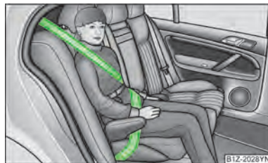
图 22 安装在后排座椅上的3级儿童座椅
