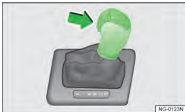
图 130 带锁止按钮（箭头所示）的自动变速器选档杆
