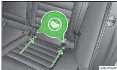
图 17 ISOFIX 装置的固定点
