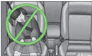
图 16 坐姿不正确、未使用儿童安全座椅的儿童会受侧面安全气囊的伤害
