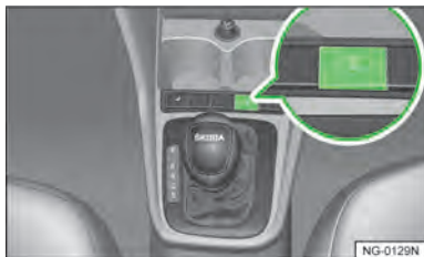
图 142 被动式轮胎气压监控系统设定按钮
