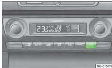
图 71 后窗玻璃加热
