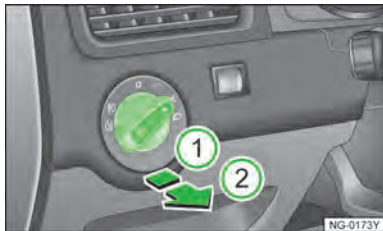
图 66 仪表盘局部视图：灯光开关
