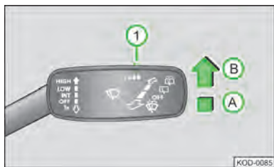
图 76 风窗玻璃刮水器操作杆：调节雨量传感器 1
