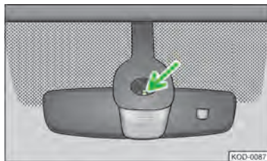
图 77 雨量传感器的传感表面。
