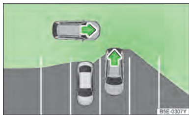
图 158 驶出车位辅助原理图：车辆驶出停车位时车后左右两侧监控
