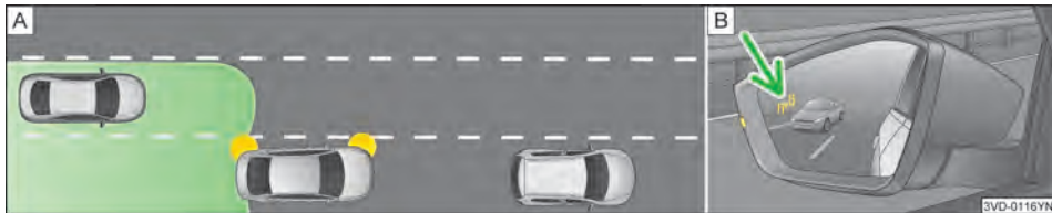
图 156 原理图：A：后方有车超车的行驶状况。B：左侧车外后视镜上的盲区监控传感器显示
