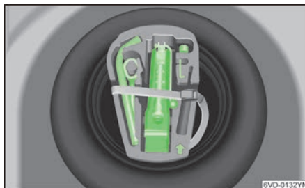
图 152 随车工具和备用轮胎放置在行李厢地毯下的备胎舱内。
