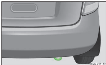
图 161 后牵引环：后牵引环位于后保险杠右下方
