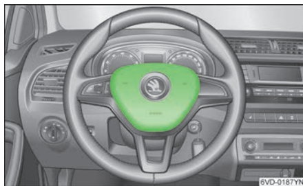
图 116 方向盘上的驾驶员正面安全气囊
