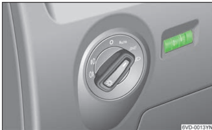
图 42 大灯照射距离调节旋钮
