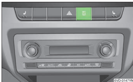
图 134 被动式轮胎气压监控系统 设定按钮
