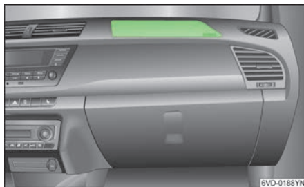
图 117 仪表板上的前排乘员正面安全气囊
