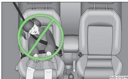
图 122 坐姿不正确、未使用儿童安全座椅的儿童会受侧面安全气囊的伤害
