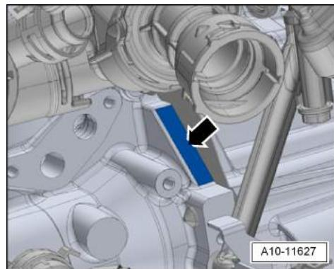
发动机标识字母和序列号信息亦可在正时皮带护罩上的粘纸上进行查阅-箭头-。
