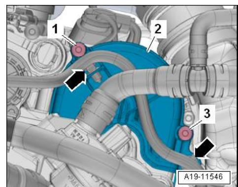
以发动机运转方向转动曲轴皮带盘，对整个冷却液泵齿形皮带进行如下检查：
